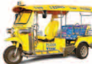
A empresa Tuk Tuk Company desenvolveu 40 táxis elétricos (com três rodas) para serem utilizados em Roterdã, na Holanda
